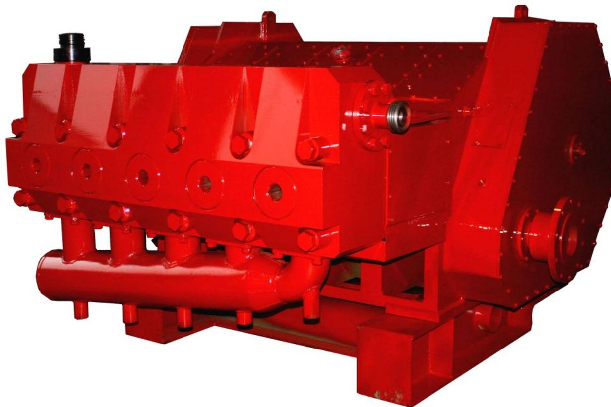
KQZ2800 泵是一种往复式、容积式、单作用、卧式五缸柱塞泵，该泵的最大输入功率为 2800hp。该泵广泛地用于间断性油井作业大功率压裂工况。KQZ2800 型柱塞泵主要配置在各种压裂车上，如 2500 型压裂车。
