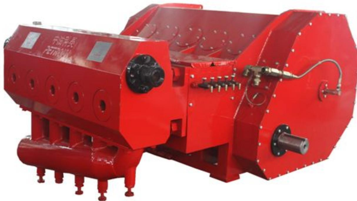
KQZ2500 泵是一种往复式、容积式、单作用、卧式五缸柱塞泵，该泵的最大输入功率为 2500hp。该泵广泛地用于间断性油井作业压裂工况。KQZ2500 型柱塞泵主要配置在各种压裂车上，如 2300 型压裂车。
