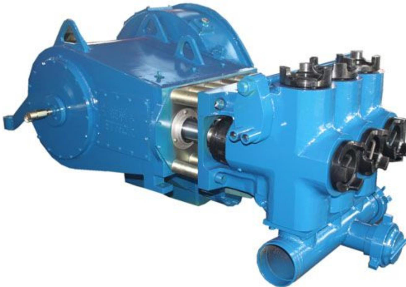
KTZ400 泵是一种往复式、容积式、单作用、卧式三缸柱塞泵，该泵的最大输入功率为 600hp。该泵广泛地用于间歇式油井作业，如酸化、固井、压裂、注水等工况。具体车型：水泥车（撬）如 GJC(Q)77-15、GJC(Q)77-30。
