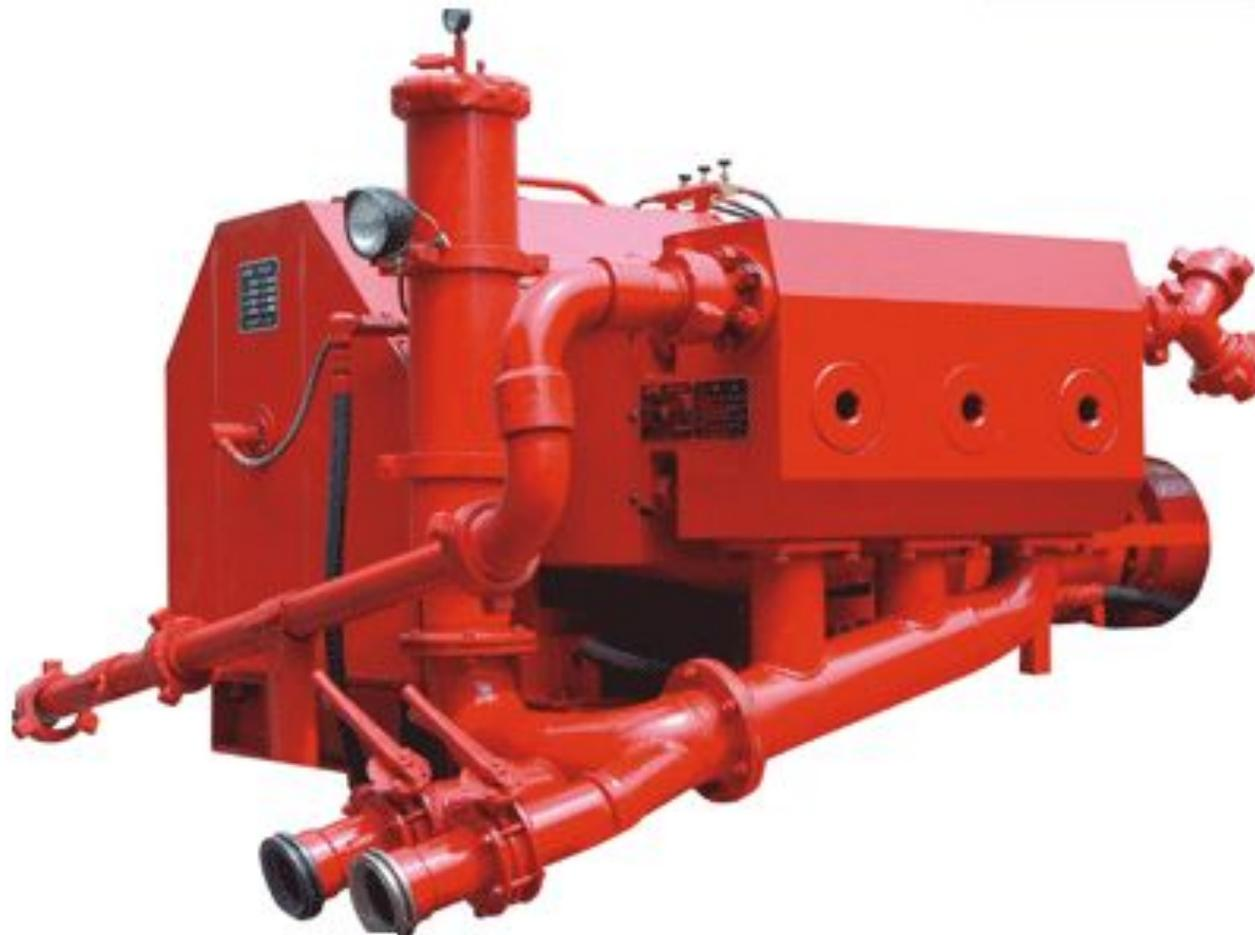
KTZ2000 泵是一种往复式、容积式、单作用、卧式三缸柱塞泵，该泵的最大输入功率为 2000hp。该泵广泛地用于间断性油井作业，如酸化、压裂、压井等工况。KTZ2000 型柱塞泵主要配置在各种压裂车上，如 2000 型压裂车。
